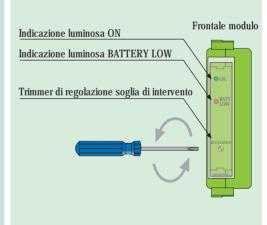
Per effettuare la taratura occorre collegare in ingresso, sui morsetti + e -, la tensione di riferimento alla quale si vuole regolare il punto di intervento del modulo; poi regolare il trimmer presente sul frontale finchè non si accende il led rosso BATTERY LOW. Il valore di tensione deve essere compreso tra 7.5 e 12.5Vdc.
